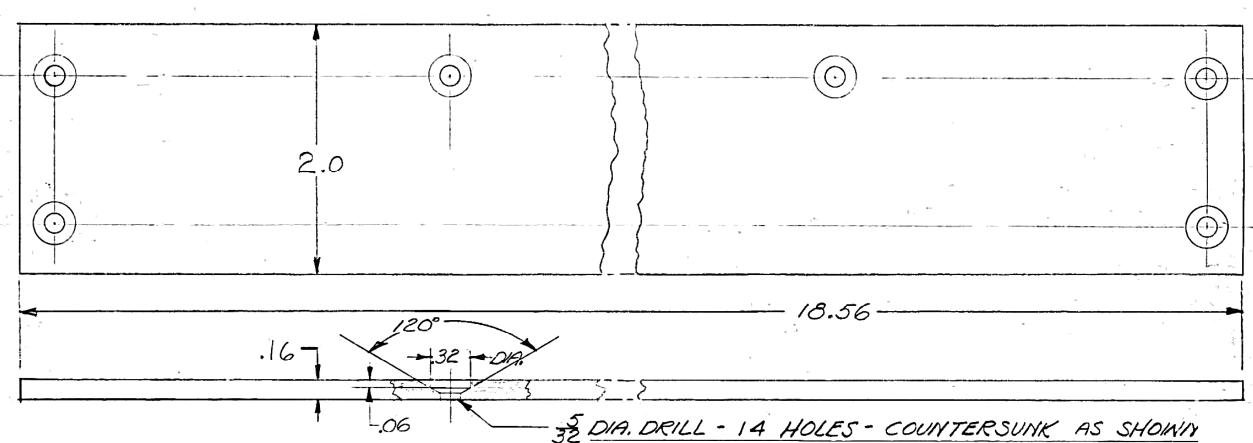
32 DIA. DRILL - 14 HOLES - COUNTERSUNK AS SHOWIN HOLES TO BE LOCATED TO MATCH HOLES IN BRAKE BAND GP 2611
